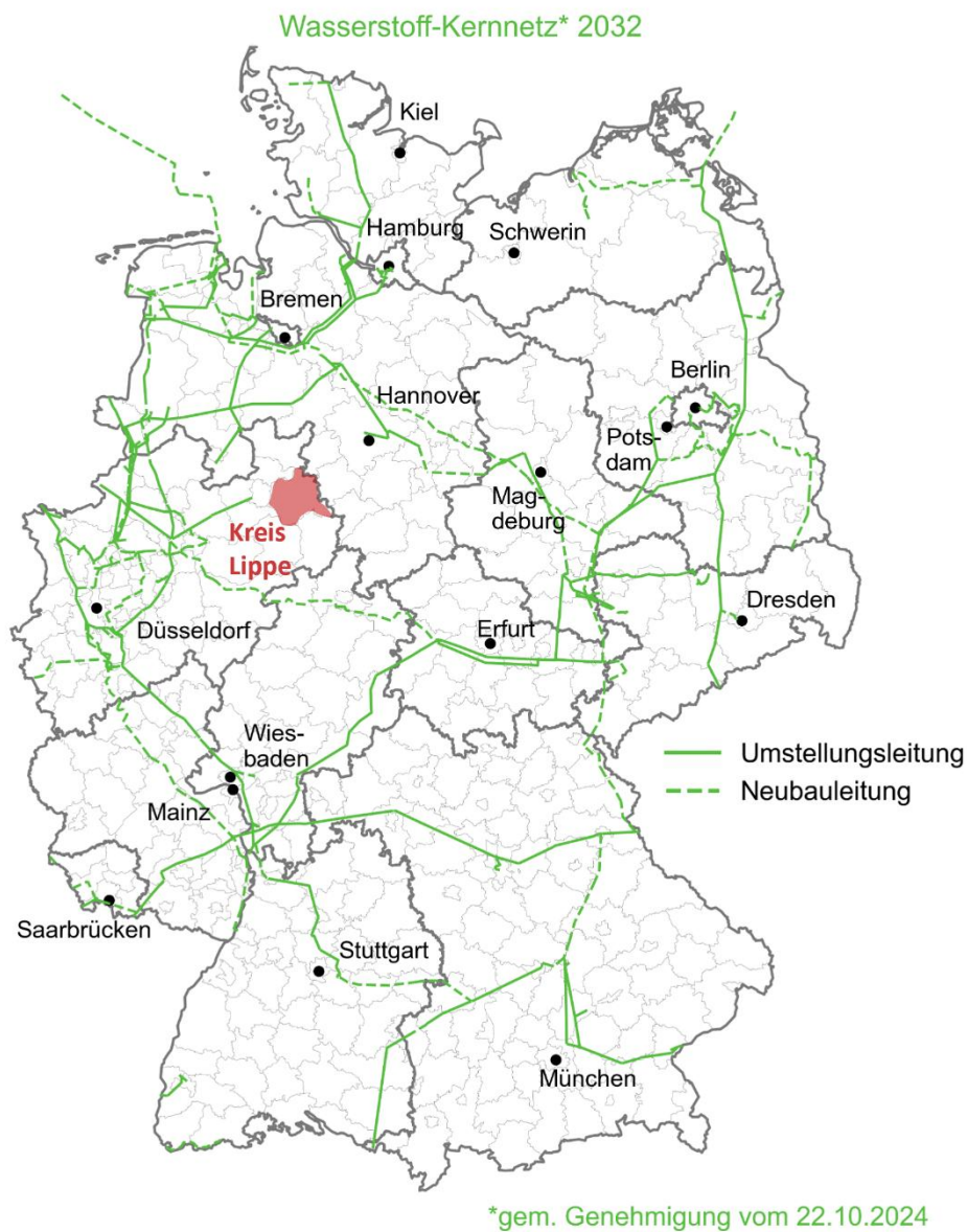
Abbildung 4: Stand Wasserstoffkernnetz gemäß Genehmigung vom 22.10.2024. Quelle: FNB [2] mit eigener Darstellung des Kreises Lippe
