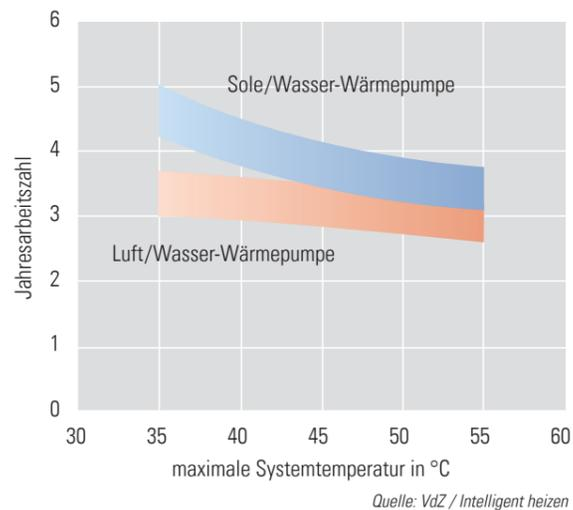
In der oben angeführten Grafik sind die JAZ anhand der jeweiligen Systemtemperaturen für Sole-/Wasser-Wärmepumpen und Luft-/Wasser-Wärmepumpen abgebildet. Je niedriger die Systemtemperatur, die die Wärmepumpe liefern muss, desto höher ist die Jahresarbeitszahl und desto niedriger zugleich die Energiekosten.
