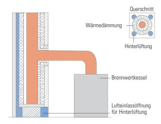
Luft-Abgas-Schornstein-System (LAS) (Zufuhr der Verbrauchsluft über Dach und Schacht)
